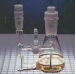
定電流電解法で有機超伝導体の単結晶を育成 (写真:森研究室)
