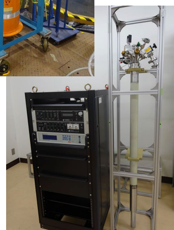
図 2, 3：電磁石付希釈冷凍機 （上：超電導電磁石付冷凍機、 下：希釈冷凍機インサートと電源）
